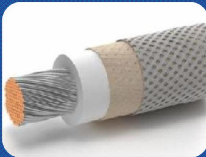
В качестве изоляции используются ПВХ пластикат, стекловолокно, полиэфирные нити, фторопластовые и полиимидно-фторопластовые пленки. Электрический экран служит для выравнивания электрического поля и защиты проводов от воздействия внешних электромагнитных полей. Экран изготавливается в виде оплётки из медной, медной луженой, медной никелированной или медной посеребренной проволоки. Защитный покров, как правило, из термостойких волокон или лент, пропитанных специальными составами.
